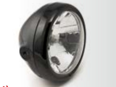
1) Scheinwerfer Six Days , 160mm Klarglas, H4, Lampenring schwarz oder verchromt, mit E-Prüfzeichen.
