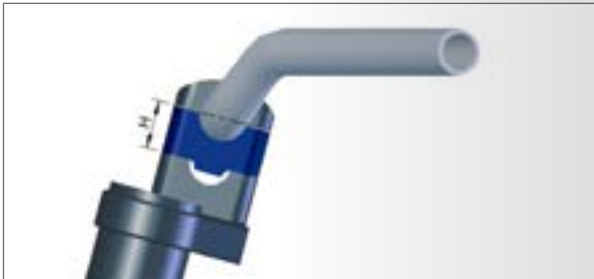
Distanzböcke werden zwischen die Originalklemmung montiert und erhöhen die Lenkerposition um 25 bzw. 30 mm (H).
