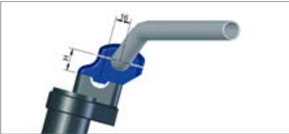
RiseUp Klemmböcke bringen die Lenkerposition 25 mm hoch und 16 mm auf den Fahrer zu.
