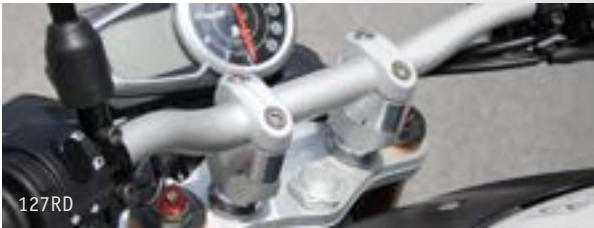
Distanzböcke werden zwischen die Originalklemmung montiert und erhöhen die Lenkerposition um 25 bzw. 30 mm (H).
