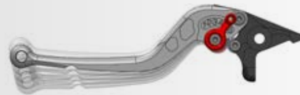
Positionen Kupplungshebel: 1-4 näher; 5 ca. Originalposition; 6 weiter.
