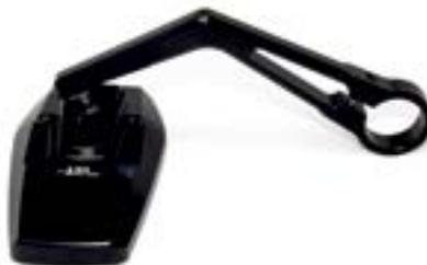
Der extrakleine Lenkerendenspiegel in der Form des Gonia®. Er wird auf das Lenkrohr geklemmt und kann rechts und links montiert werden. Die optionalen Lenkerendstücke machen das Versetzen der Lenkerarmaturen überflüssig. Eine Reduzierhülse erlaubt die Montage auf 22 mm- und 1"-Lenkern.
