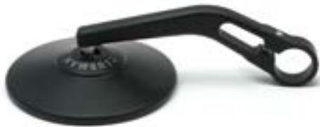
Diese Variante verfügt über eine größere Spiegelfläche und erfüllt somit die ECE-Norm. Durch die korrosionsbeständige Edelstahl-Kugelklemmung ergibt sich ein großer Einstellbereich. Die optionalen Lenkerendstücke machen das Versetzen der Lenkerarmaturen überflüssig. Er passt auf 22 mm und 1"-Lenkern.
