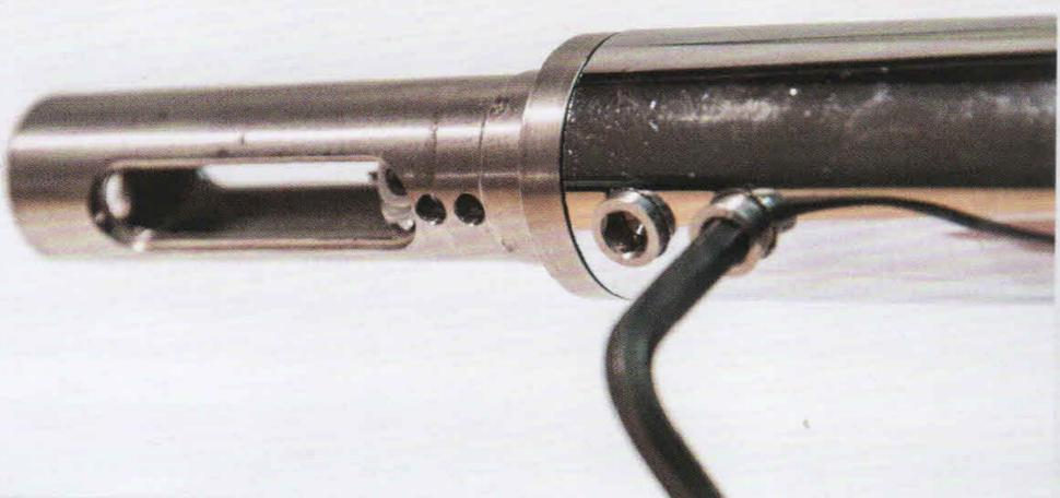
**13** Das Griffstück wird mit dem Lenker verschraubt
