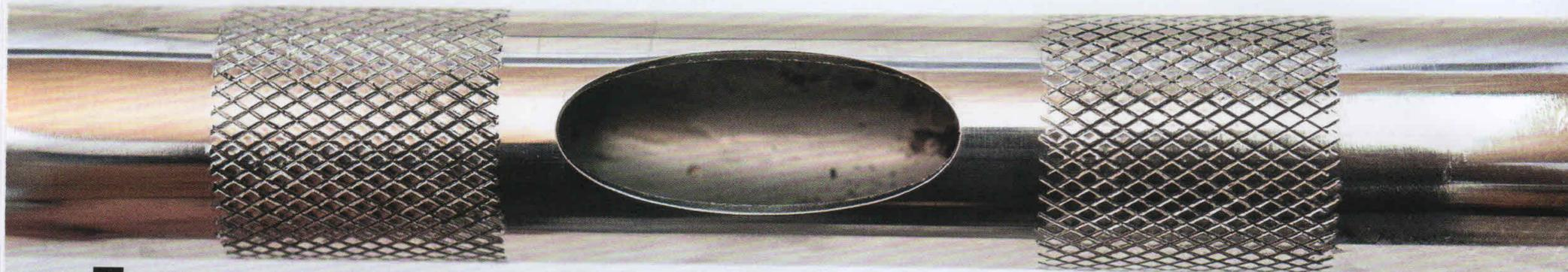
**1** Der Lenker sollte über eine Kabeldurchführung verfügen
