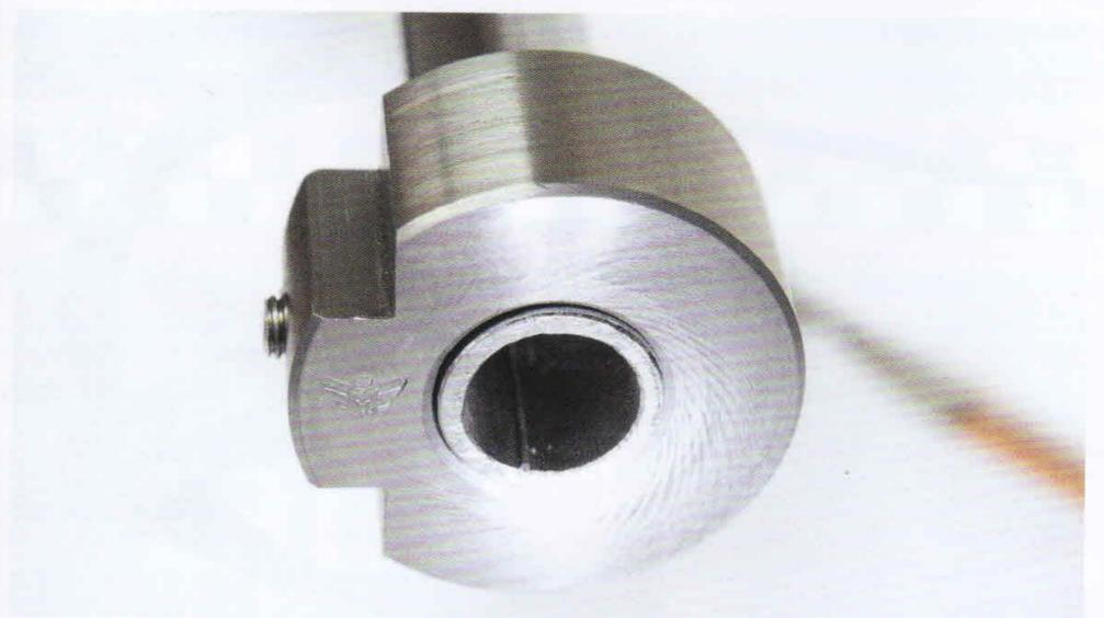
**8** Mittels angefrästem Zapfen kann das Hilfsmittel in den Schraubstock gespannt werden
